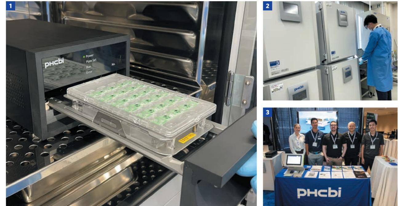
▲ 1. 市販の細胞培養プレートに取り付けたLiCellMoセンサーモジュールを、CO<sub>2</sub>インキュベーター内のディテクターに配置する。
