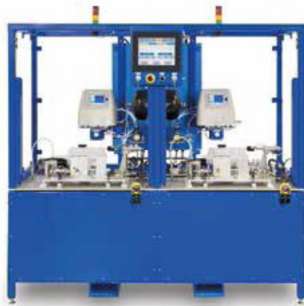
自動車のクーラントタンク用デュアルステーションリークテスター
