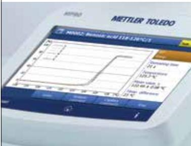
透過光の自動検出とビデオによる観察を組み合わせることで、融点、上昇融点、沸点、曇点を高い信頼性で確実に測定できます。標準偏差と平均値を使用した統計評価により非常に信頼性の高いデータが得られます。
