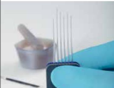
サンプル調製は時間がかかる場合があります。メトラー・トレドの革新的なサンプル調製ツールは最大で6つのサンプルを保持でき、正しい充填プロセスを簡単に実施できます。独自の設計によって、機器にキャピラリーを直接挿入することができます。
