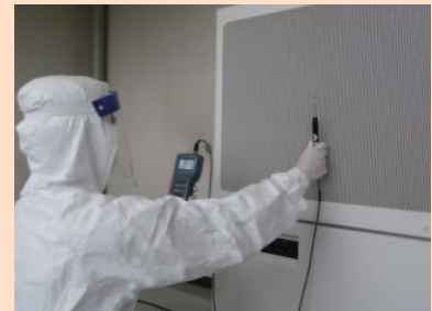
本来の性能が確保されているか検査します。
