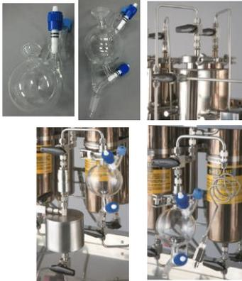
溶媒取出口はフラスコ各種、グローブボックス持込用カラム、ルアーロック併用、グローブボックス配管接続などお客様の研究室に合わせた多彩なバリエーションから選択いただけます。※オプション対応
