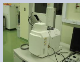
走査型電子顕微鏡 / エネルギー分散型 X 線分光装置 (SEM-EDX)
