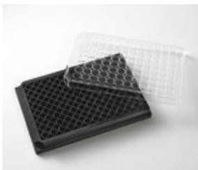
コート済みですぐに使用できます。マトリゲル基底膜マトリックスが96ウェルのハイスルーブットフォーマットの各ウェルに分注されており、3D細胞培養に最適です。3D細胞培養の「オントップ / サンドイッチ法」、「包埋法」いずれでも使用できます。
