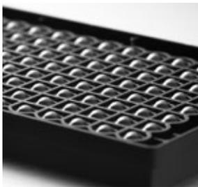
新しい独自デザインの透明丸底と黒いウェル壁面のマイクロプレートは、1枚のプレート内で三次元多細胞性スフェロイドの作成と解析を行うのに理想的です。超低接着表面が均一で再現性のある三次元多細胞性スフェロイド形成を可能にしました。透明丸底の底位置まで達する長めの黒色ウェル壁によりウェル間のクロストークを抑えます。
