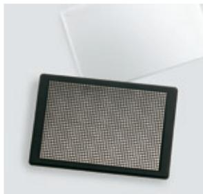
新しい独自デザインの透明丸底と黒いウェル壁面のマイクロプレートは、1枚のプレート内で三次元多細胞性スフェロイドの作製と解析を行うのに理想的です。超低接着表面が均一で再現性のある三次元多細胞性スフェロイド形成を可能にしました。透明丸底の底位置まで達する長めの黒色ウェル壁によりウェル間のクロストークを抑えます。
