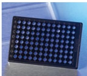
厚み127 μm の非常に透明度の高いフィルムは、プレート全体とウェル内の平滑性にすぐれ、高解像度細胞イメージングに理想的です。マイクロプレートとフィルムはサイクリックオレフィンコポリマー (COC) を使用しており、優れた光学特性、薬品耐性、力学的な安定性をもちます。
