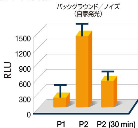
バックグラウンドの発光は、マイクロプレートを使用前に暗所に保管することにより低減可能。
