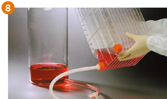
ポンプを使わず、細胞懸濁液を注ぎ込んでも同様の作業が行えます。セルスタックを注入口に向け、やや傾け、滅菌したボトルに細胞懸濁液を泡が立たないように注ぎます。
