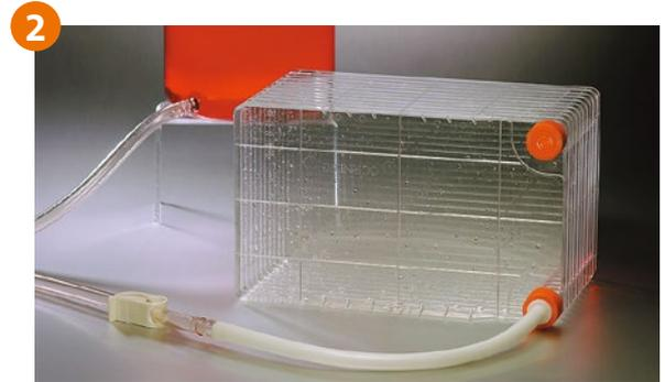
2 ベントキャップを取り外し、フィリングキャップ（カタログ番号 3282 または 3283）に付け替え、キャップがついている面が横になるように横倒しにします。フィリングキャップと滅菌済みの下口びんをクランプをつけたチューブでつなぎます。下口びんには適量（培養に必要な量）の細胞懸濁液を入れます。
