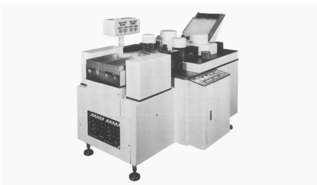
アンプル用自動検液機1号機 AIM275（1975年）
