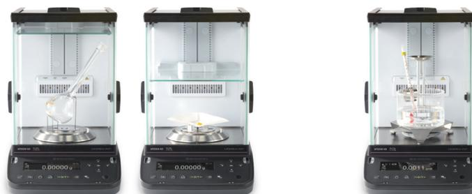
5 mm単位で高さ調整が可能。使用する容器や試料に応じて高さを調整し、ひょう量室内を最適な状態にします。
