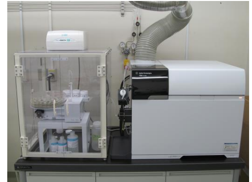
図 1 ICP/MS 装置 Agilent 7900
