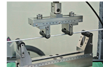
ロッドの4点曲げ試験
