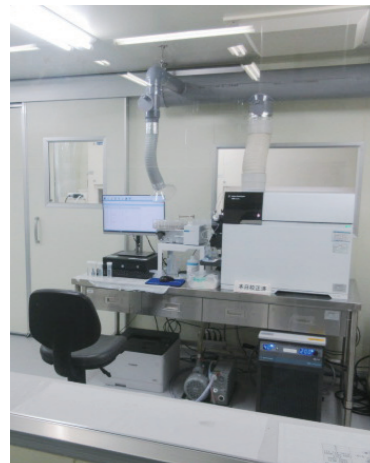
クリーンルーム内の誘導結合 プラズマ質量分析装置 (ICP-MS)
