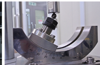
歯科インプラントの圧縮曲げ疲労試験
