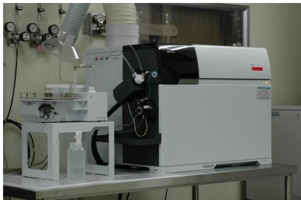
図1 ICP質量分析計による測定
