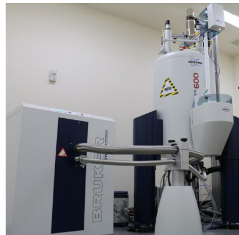
写真1 クライオプローブ搭載NMR 装置外観 ※NMR: Nuclear Magnetic Resonance
