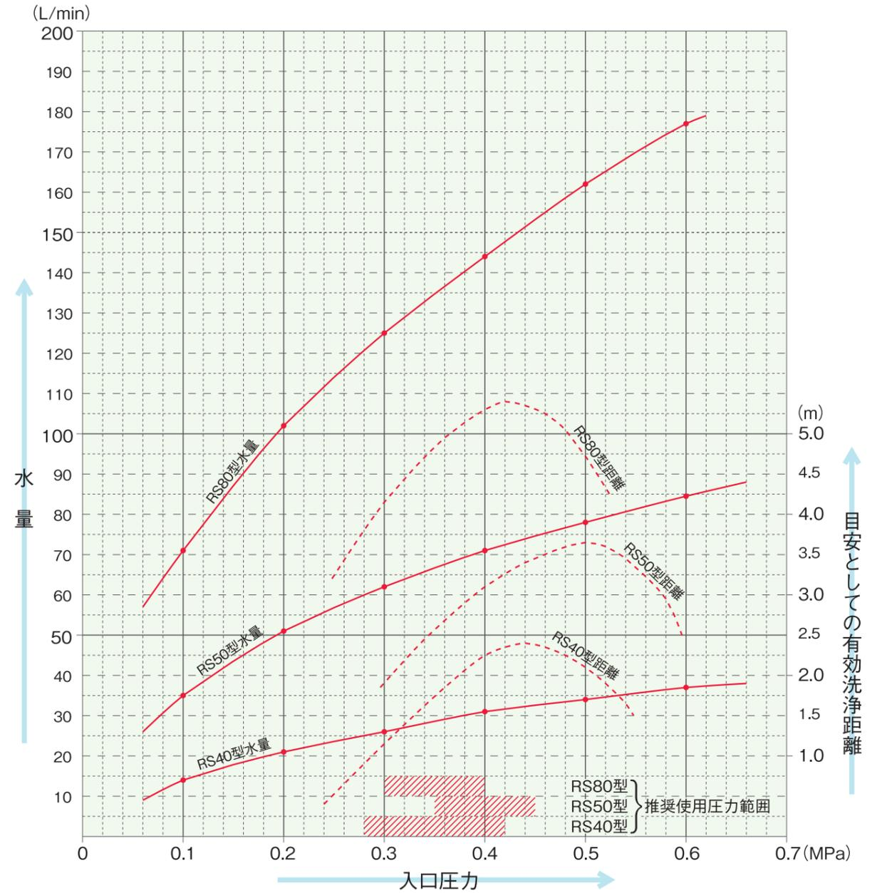
注) 推奨使用圧力範囲での、ヘッド回転数は3~8rpmを目安としてください。
