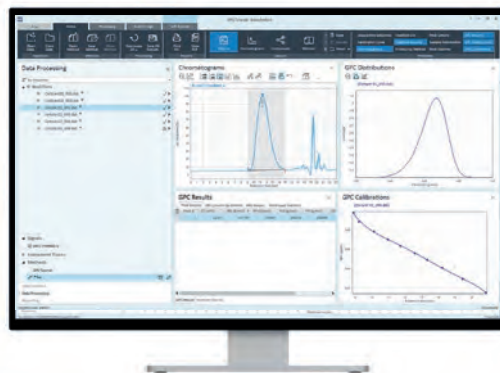
OpenLab CDS アドオン GPC/SEC ソフトウェアでポリスチレンサンプルのクロマトグラムと分子量分布を表示しています。
