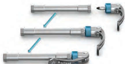
クイックコネクTFittingは、 手締めで接続した後、レバーを閉じるだけで 130 MPa まで使用可能です。
