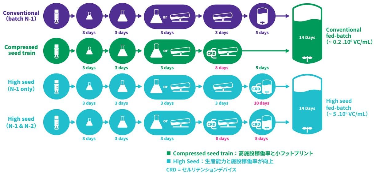
図 2. パーフュージョン培養により、N-1 バイオリアクターの細胞密度を増大させ、製造プロセスを加速することで効率を向上。細胞密度を高めるためにパーフュージョン培養をシードトレインに導入することで、バイオリアクター数を削減でき、産生タンパク質の目標 Titer に到達する時間を短縮。
