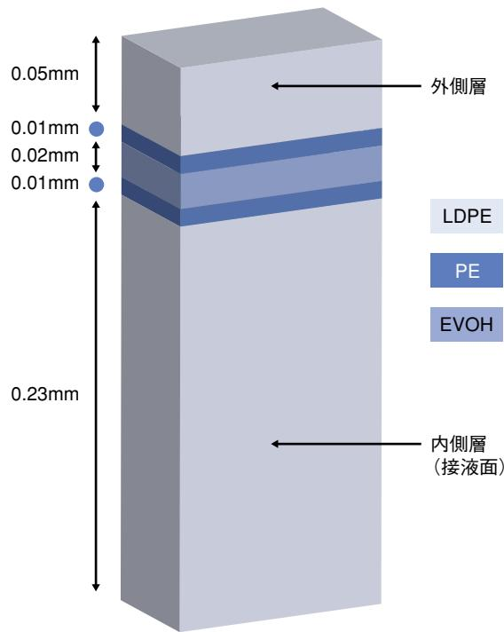
Allegro バイオコンテイナーのフィルムは、最先端のフィルム構造を有しています。これらは共押出法により製造され、内側層と外側層は低密度ポリエチレン(LDPE)、酸素バリア層はEVOH、エチレンビニルアルコールからなります。大変シンプルな構造が卓越した気体透過防止性能を発揮し、なおかつ溶出物(Extractables)、浸出物(Leachables)を最小限に抑えます。酸素に影響されやすい製品の使用にも最適です。
