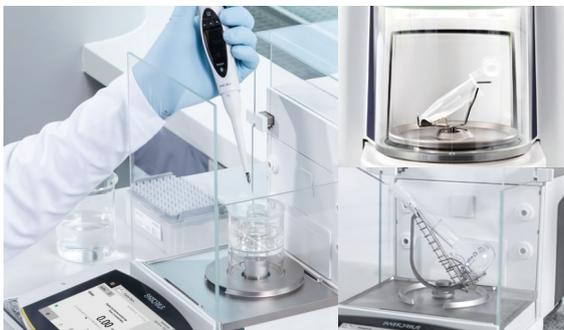
さまざまなタイプの容器（マイクロ・コニカルチューブやフラスコなど）に対応したサンプルホルダーを使用し、容器に直接ひょう量することでサンプルのロスを防ぎます。また安定所要時間が短縮され、繰り返し性も向上します（オプション対応品）。
