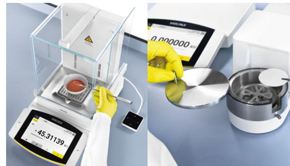
分析・1 mgモデルにはイオナイザー内蔵の自動ドア式ガラス風防が選択可能。粉体や樹脂サンプルからの静電気による指示値のばらつきを軽減し、精度と作業効率を高めます。ウルトラマイクロ・マイクロ天びんには環境測定やエンジン排ガス試験向けにフィルターひょう量用風防も選択できます。
