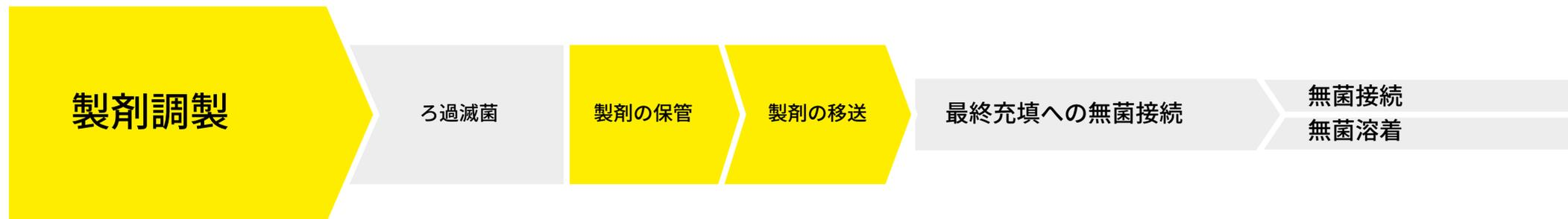
製剤に対応する Flexsafe® 2D アドバンスソリューションは、Sartopore® プラチナ 0.45|0.2 μm を特徴とします。改良されたメンブレンの優れた湿潤特性により、フラッシング容量が 1/10 に削減され、使用前のフィルター完全性試験がしやすくなります。
