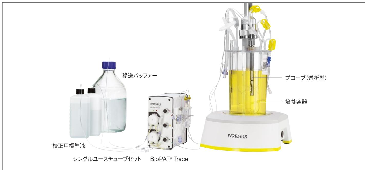
図1: BioPAT® TraceとUnivessel® SUのセットアップ例
