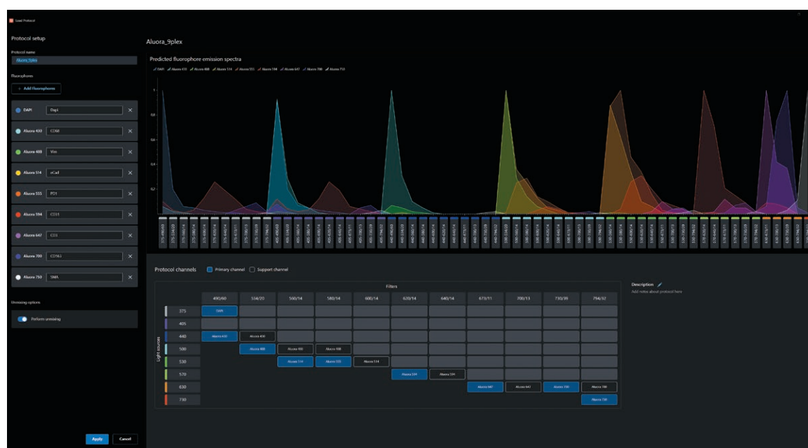
図4. EVOS S1000 Spatial Imaging Systemは、スペクトルアンミキシング機能によりマルチプレックスイメージングのデータを生成。この機能により、全てのチャンネルを同時に可視化でき、高分解能データを容易にするための品質メトリクスレポートを提供します。
