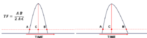
図1. テーリングファクター (TF) ランキングポイントを示すサンプルクロマトグラム
