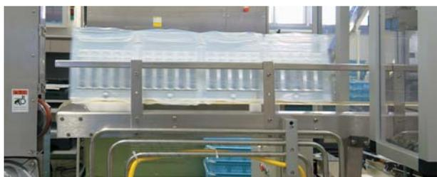
注射剤の滅菌工程を行う生産ラインにパルスドキセノン殺菌/滅菌装置を組み込むことで、生産性の劇的な向上が図られている。
