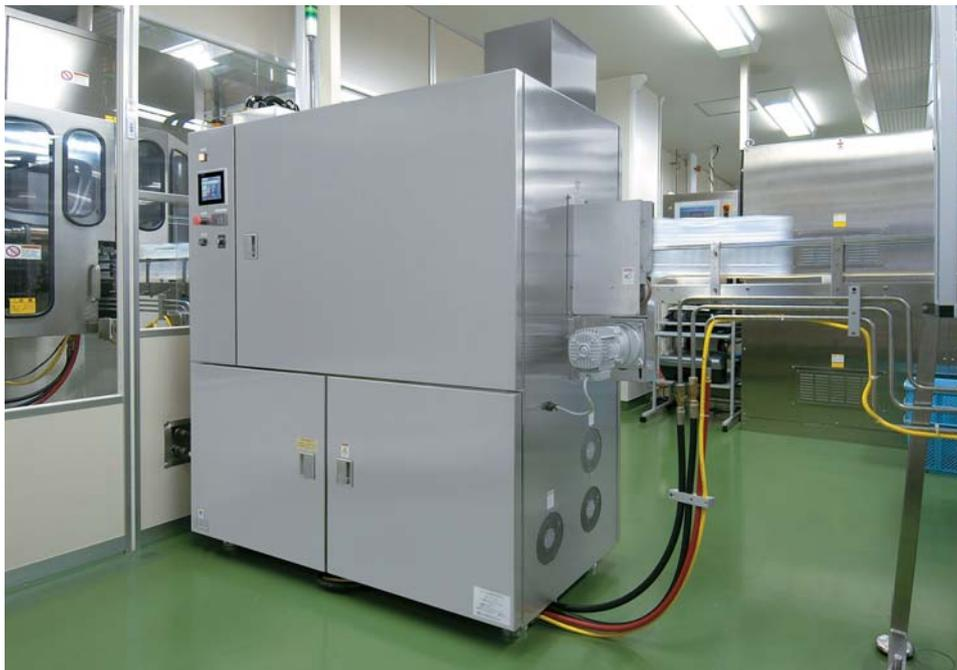
薬剤生産ラインの最終滅菌工程に使用されているパルスドキセノン殺菌/滅菌装置。
