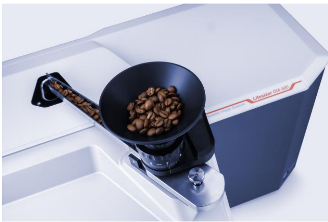
図2：乾式自由落下分散ユニットの大型振動ホッパーとシュートにより、コーヒー豆を分析可能
