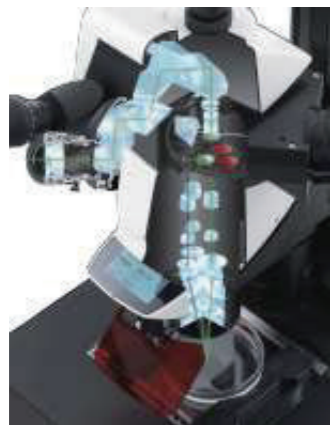
Triple Beam 蛍光光路 (M205FAの例)
