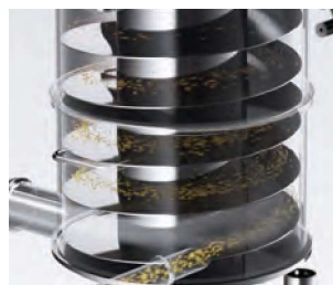
⑥二次乾燥 顆粒はらせん形状の気流乾燥部を熱風気流にて搬送されながら乾燥します。
