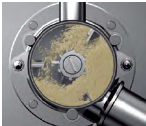
①原料混合 スパルタンミキサー 混合容器中央の大型チョッパーにより、極めて短時間にて精密混合を完了させます。
