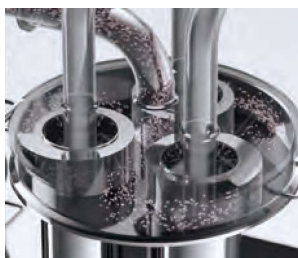
⑦回収 多連式サイクロンにより、熱風と粒子を効率よく分離します。製品は下部にて回収され、空気輸送にて次工程へ搬送されます。
