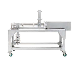
⑧連続滑沢剤混合 DOME-EX SYSTEMで製造された顆粒に滑沢剤を混合します。最終の打錠工程へ搬送します。
