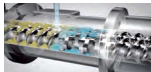
②③定量供給・加水混練 ロードセル内蔵のスクリー式供給機にて混合粉体を安定よく混練ゾーンに定量供給します。 2軸のセルフクリーニング式スクリーにて連続的に混練します。混練羽根組数と回転速度にて混練度をコントロールします。
