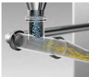
⑤一次乾燥 加熱圧縮空気にて瞬間的に顆粒表面を乾燥させます。表面を乾燥させることにより顆粒の凝集や装置への付着を防止します。
