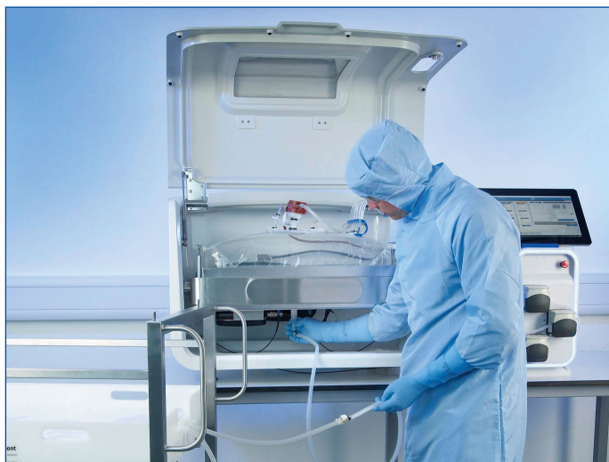
一体型ドレンによる回収操作の単純化
