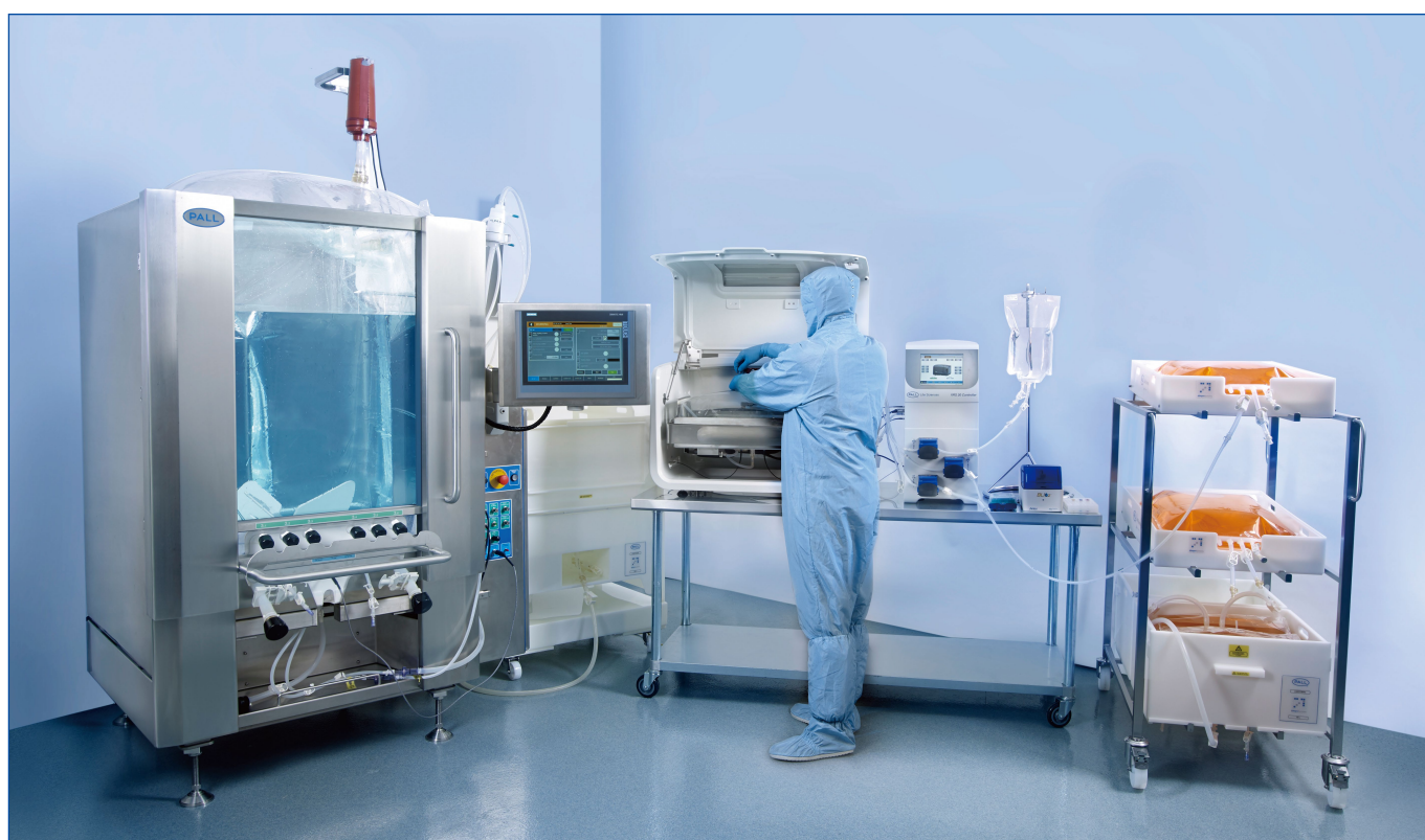
アレグロ XRS 25 バイオリアクターシステムのアップストリームプロセスへの導入
